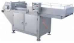
**Блокорезка роторного типа QR 5230**
