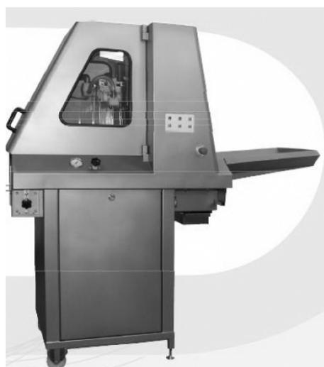
Инъектор Многоигольчатый PSM 182 – 3.0 ZD (182 игл, диаметром 3,0 мм, произв. до 6000 кг/час, центробежный насос, рабочая ширина 411 мм)
