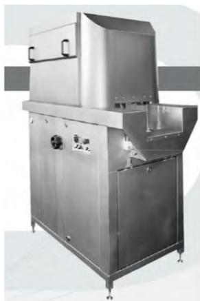
Инъектор Многоигольчатый PSM 100 – 4.5 ZD (100 игл, диаметром 4,5 или 3,0 мм, произв. до 4500 кг/час, центробежный насос, рабочая ширина 411 мм)
