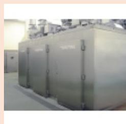
Камера универсальная варочно-копильная UKM-2002-E и UKM-2002X2-E (двухрамная и четырехрамная термокамера, размер копильных рам 100\*100\*198 см, нагрев электрический, дымогенератор – щепы, микропроцессорное управление aditec MIC 2018, исполнение - туннельное)
