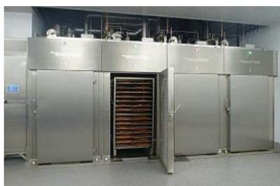
Камера универсальная варочно-копильная UKM-2003-E трехрамная, UKM-2004-E четырехрамная, UKM-2006-E шестирамная размер копильных рам 100\*100\*198 см, нагрев электрический, дымогенератор – щепы, микропроцессорное управление aditec MIC 2018, исполнение – туннельное.
