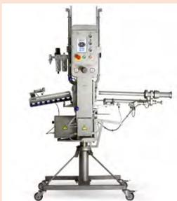
Клипсатор KH-32 Автоматический двухскрепочный с подачей петли
