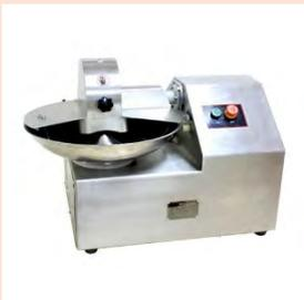
Куттер не вакуумный Миф-5К (объем чаши 5 литров, 1 скорости ножей 1400 об./мин., 1 скорости чаши 70 об./мин.) , Производительность, кг/ч 80, Мощность двигателя, кВт 0,37
