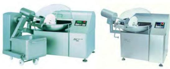
Вакуумные куттер MSM 769 VA-SL-220L (объем чаши 220 литров, плавная регулировка скоростей ножей 500 - 5000 об./мин., смешивания 50 - 500 об./мин., чаши 8 - 20 об./мин., с автоматическим выгрузателем, с автоматическим загрузочным устройством для 200-литровой тележки, вакуумный насос 160 м/час)
