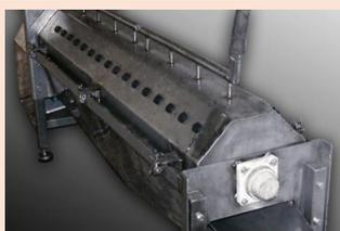
Машина чистки лапок птицы для механической очистки лапок (отрезанных предварительно от тушки птицы) от остатков пера и хитинового покрова.
