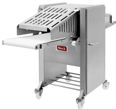
Шкуроеъемная машина для снятия шкурки со шпика Cortex CB 495 (напольная, полуавтомат, ширина среза 430 мм, производительность 24 метров/минуту, макс. высота продукта 90 мм, транспортерная лента подачи, подпружиненная подвеска прижимного вала с плавно регулируемой высотой, плавно регулируемая толщина среза)
