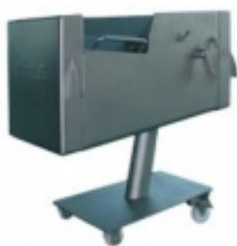
Шпигорезка SR 1 - универсальная машина для нарезки на кубики и полоски, производительность до 900 кг/час, загрузочная камера 100x100x350 мм, длина отреза от 1 до 32 мм. Возможные размеры решеток: 5x5, 10x10, 20x20, 50x50 и 6x6, 12x12, 24x24, 50x50 и 8x8, 16x16, 32x32 мм. С комплектом режущего инструмента.
