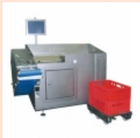
Шпигорезка SR 2 Turbo - универсальная машина для нарезки на кубики и полоски, производительность до 3000 кг/час, загрузочная камера 120x120x500 мм, длина отреза от 0,5 до 32 мм. Возможные размеры решеток: 5x5, 10x10, 20x20, 50x50 и 6x6, 12x12, 24x24, 50x50 и 8x8, 16x16, 32x32 мм. С комплектом режущего инструмента.
