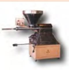
Шприц вакуумный ШВ-1 старого образца
