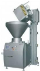
Шприц КОМПО-МАСТЕР 1100 вакуумный роторный (мощность привода 7,5 кВт)
