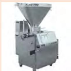
Вакуумный шприц F-Line F 190 - объем воронки 250 литров, производительность до 3600 кг/час, давление 40 бар, мощность 10,5 кВт, вакуумный насос 21 м<sup>3</sup>/час, микропроцессорное управление ТС 266 8,4" TFT, 150 программ, с сенсорным дисплеем, скорость порционирования 600 порций в мин., точность порционирования от 5 до 10000 гр.
