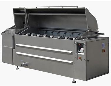
Шпарчан OSK 200 с сепаратором (сборником) щетины, для ошпаривания и снятия щетины, с двумя валами выбрасывателем туши, 20 голов в час загрузка до 200кг
