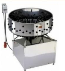
GR 4/400B (установка барабанного типа, для влажного удаления оперения с тушек домашней птицы, загрузка 4 – 5 тушек кур, время очистки 60 сек.)
